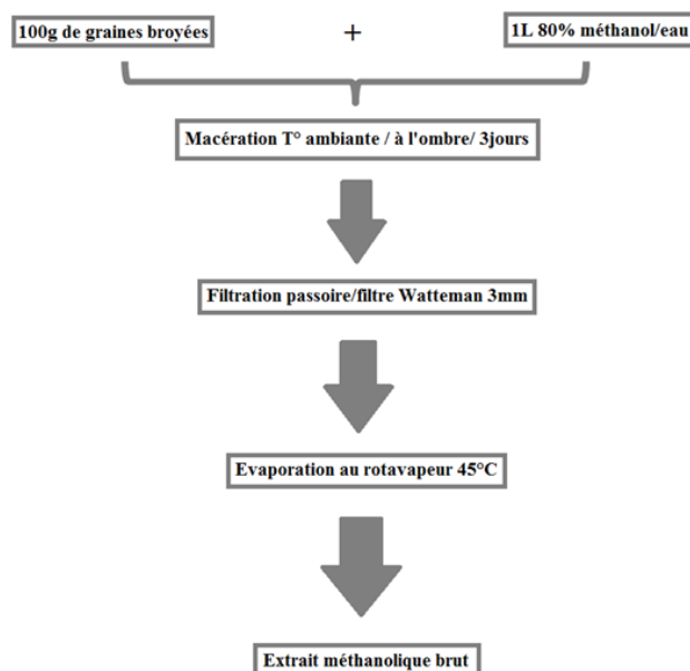
Figure 24: Représentation schématique des différentes étapes de la préparation de l'extrait méthanolique des graines de Peganum harmala .
