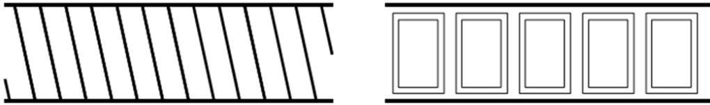
**Figure I.19 :** Rotor à cage classique et rotor de machine asynchrone "brushless"
