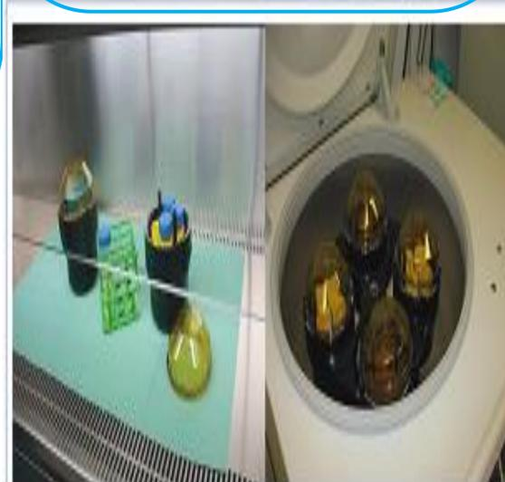
Godets étanches sous PSM et en centrifugeuse
