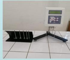
Viscosimètre Fungilab type viscoelite-H
