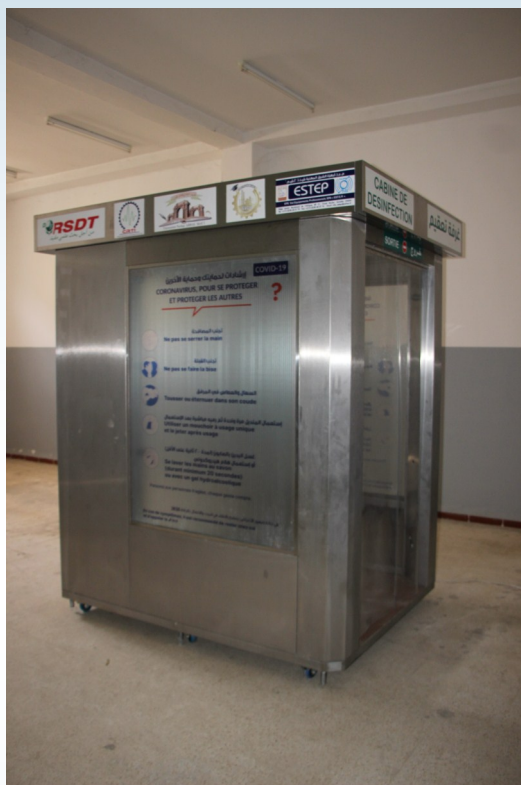
Cabine de désinfection réalisée
